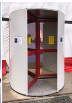
De WMHC hockeyhal in Wageningen. Door de draaideur (midden) is er geen drukverlies in de hal bij binnenkomst.
