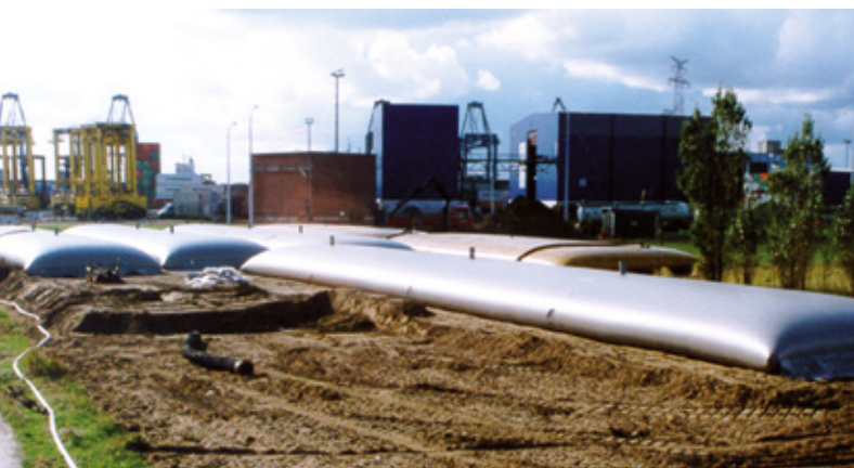
I sistemi Alligator Winbag possono essere collegati fra loro per creare una capacità di deposito maggiore e comunque mobile.
